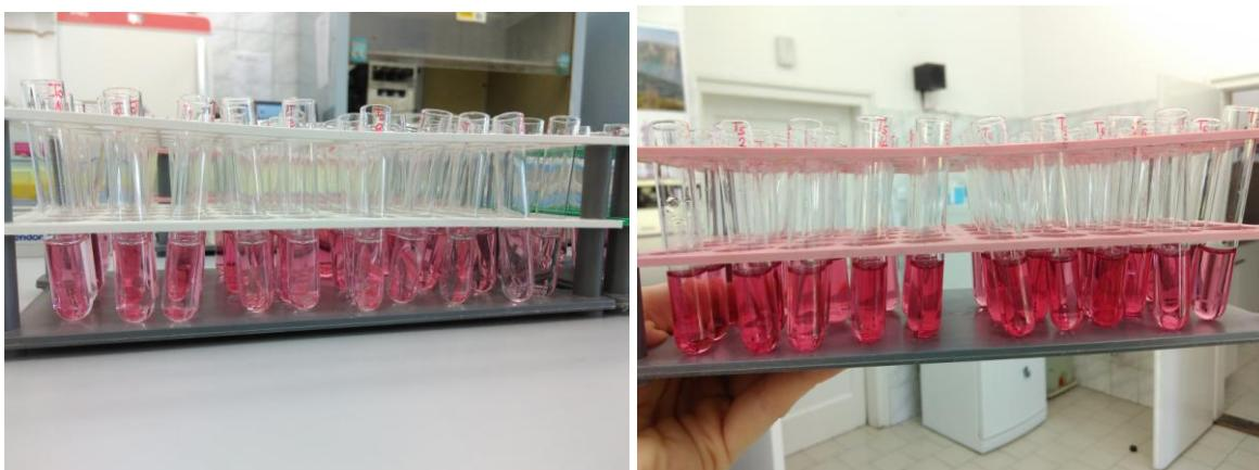
**Slika 12.** Kušalice za detekciju glukoze prije inkubacije. **Slika 13.** Kušalice za detekciju glukoze nakon inkubacije (sadrže GODOD reagens)
