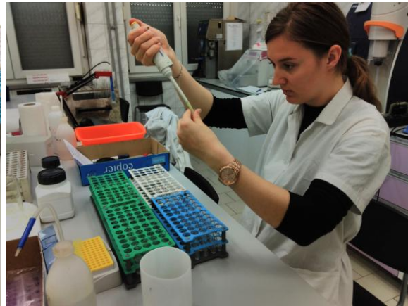
Slika 10. Priređena razrjeđenja alikvota. 11. Odpipetiravanje alikvota pripremljenih razrjeđenja za detekciju glukoze Izvor: Novaković, K. – vlastiti izvor
