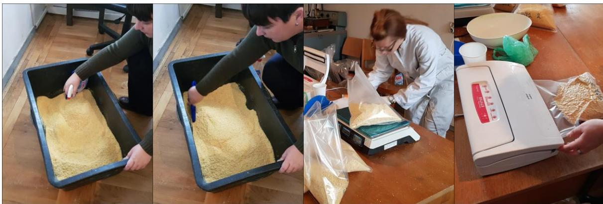
**Slika 5.** Aplikacija otopine inokulanta sprej načinom, vaganje i vakumiranje uzorka za siliranje
