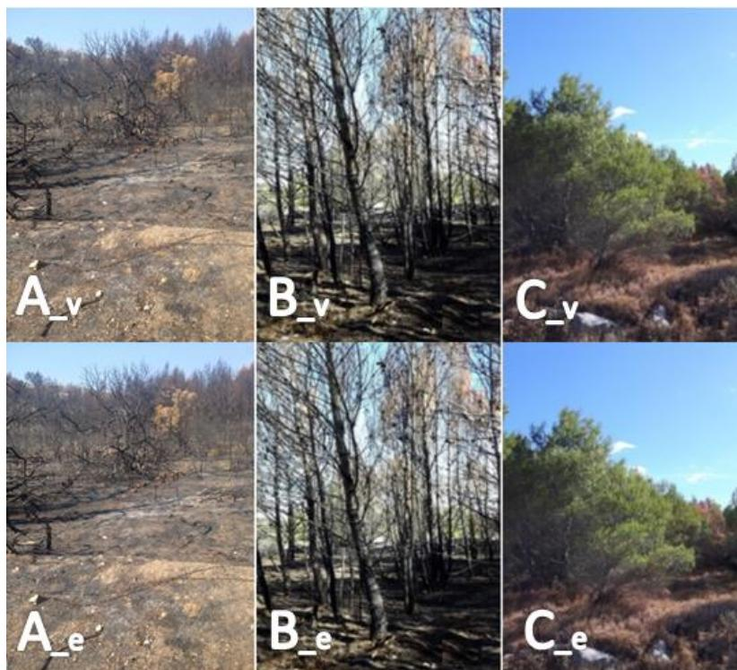
Slika 10. Foto prikaz lokacija izvođenja infiltracijskog pokusa na tri različite lokacije gdje je A - jako opožareno tlo, B - opožareno tlo i C - kontrola odnosno bez požara; index - \_v označuje infiltracijski pokus s vodom dok se - \_e odnosi na pokus izveden s etanolom kao infiltracijskom tekućinom
