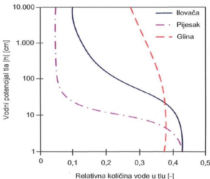
Slika 2. Glavne karakteristike retencijske krivulje tla gdje je na osi x prikazana relativna količina vode u tlu  $\theta$ , a na osi y prikazan je vodni potencijal tla  $h$ ; primjeri za teksturno raličita tla
