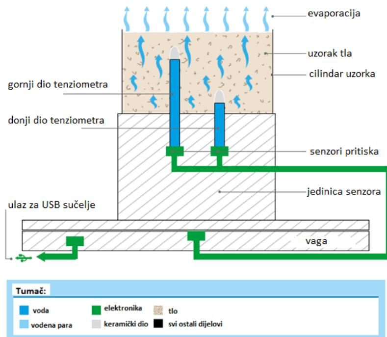
Slika 7. Shema HYPROP sustava za mjerjenje retencijskih krivulja i određivanje hidrauličkih parametara tla
