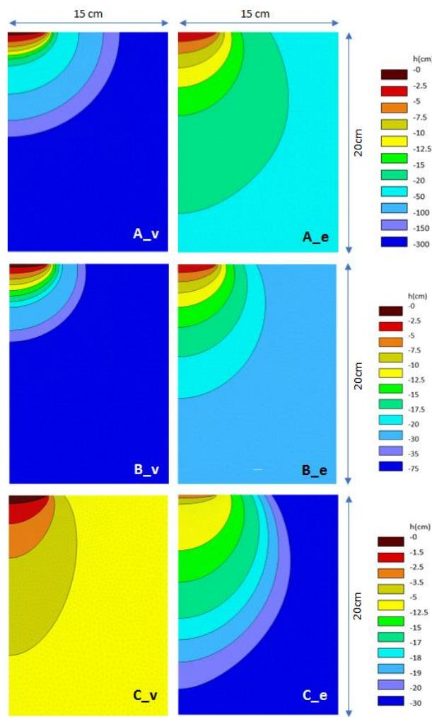
Slika 17. Distribucija vodnog potencijala tla (cm) u simuliranoj domeni за A (јако опожарену), B (опожарену) и C (kontrolну) варијанту на крају теренског infiltracijskog pokusa s vodom (\_v) i etanolom (\_e)
