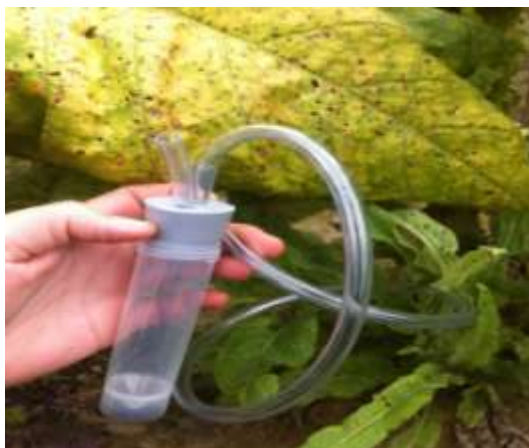
Slika 3.1. Aspirator korišten za hvatanje buhača u polju duhana
