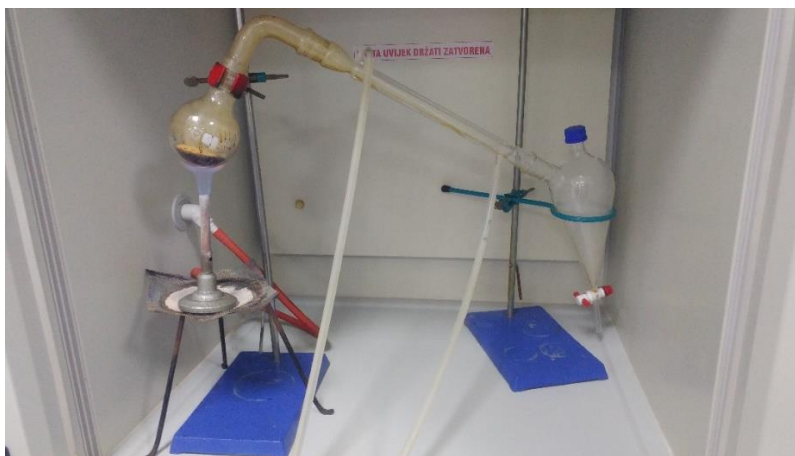
Slika 3 : Termokemijski proces pirolize (Izvor: vlastita arhiva)
