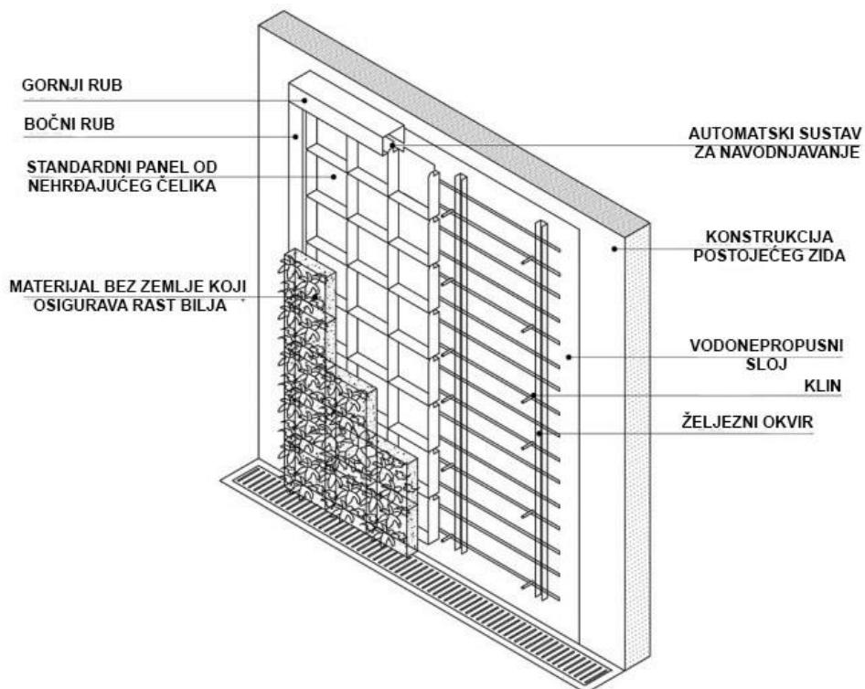
Slika 10 Primjer modularnog vertikalnog vrta (Izvor: <http://gsky.com/green-walls/pro/>)
