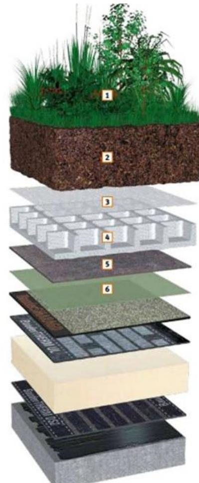
Slika 5 Shematski prikaz intenzivnog krovnog vrta (<https://www.bauder.hr/>)
