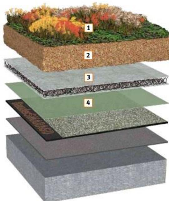
Slika 4 Shematski prikaz ekstenzivnog krovnog vrta (<https://www.bauder.hr/>)
