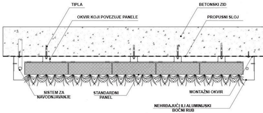
Slika 9 Horizontalni presjek modularnog sistema (Izvor: <http://gsky.com/green-walls/pro/>)
