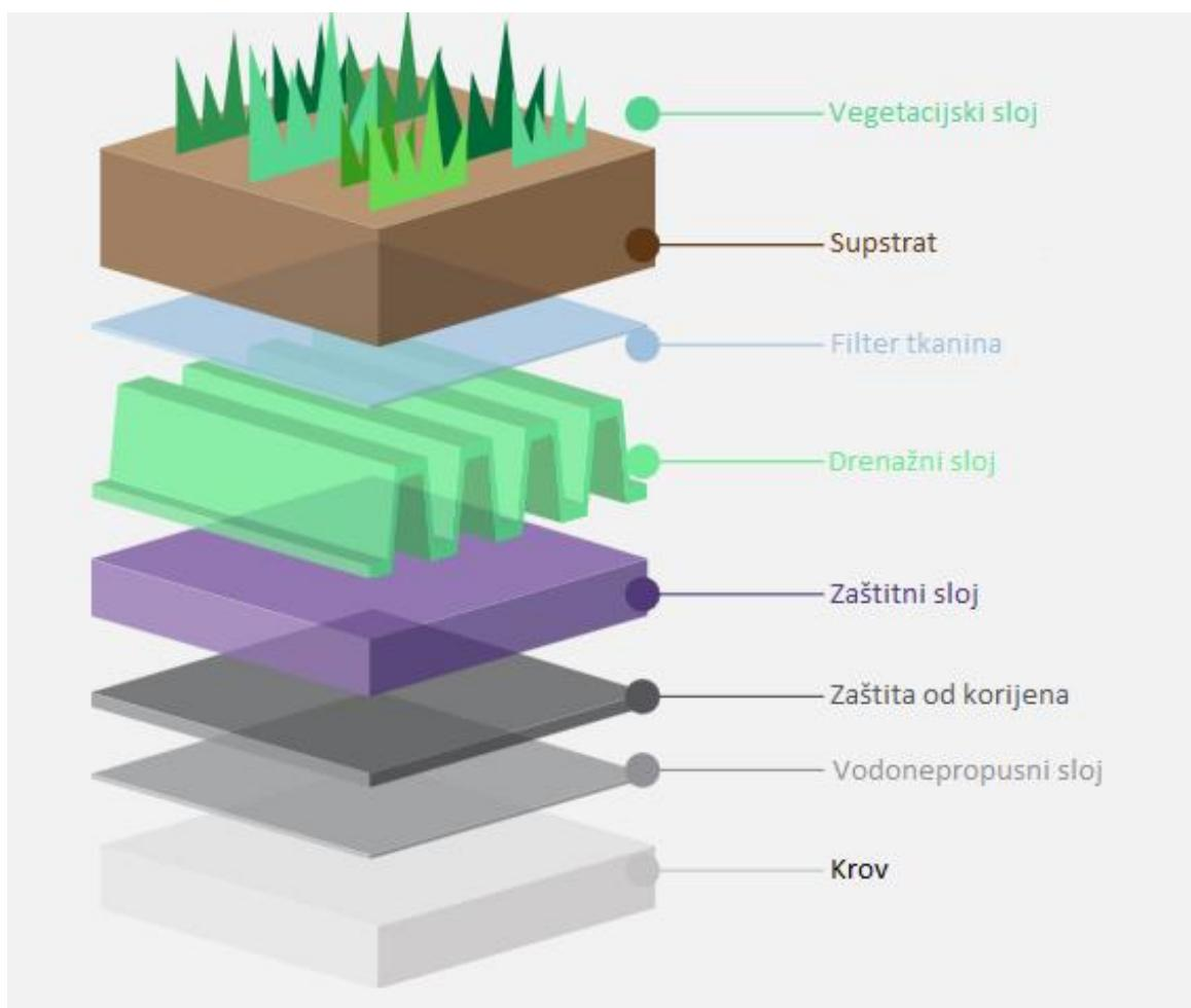
Slika 6 Presjek krovnog vrtića (Dovrak i suradnici, 2010)
