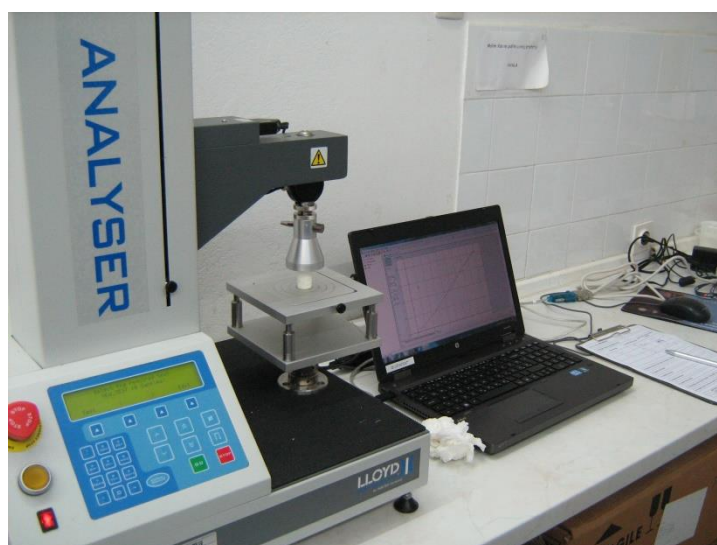
Slika 3.5.3. Test kompresije i grafički prikaz rezultata
