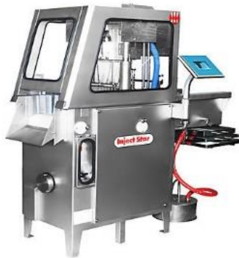
Slika 2.1.4.2. Uređaj za salamurenje mesa pikl-injektor
