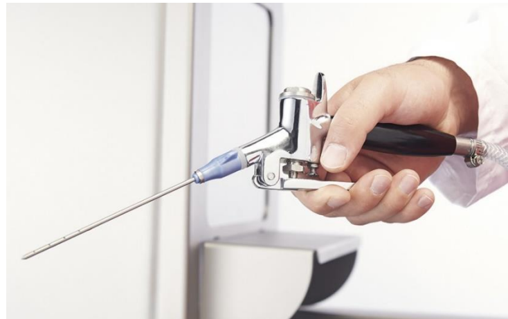
Slika 2.1.4.3. Uređaj s jednom iglom za salamurenje velikih komada mesa
