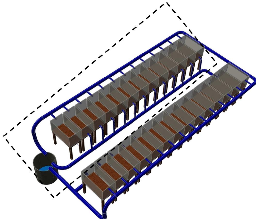
Slika 4. Dio eksperimentalnog recirkulacijskog sustava korištenog u istraživanju (Autor ilustracije: Marin Kraljev) (AutoDesks, Inc., 2009)
