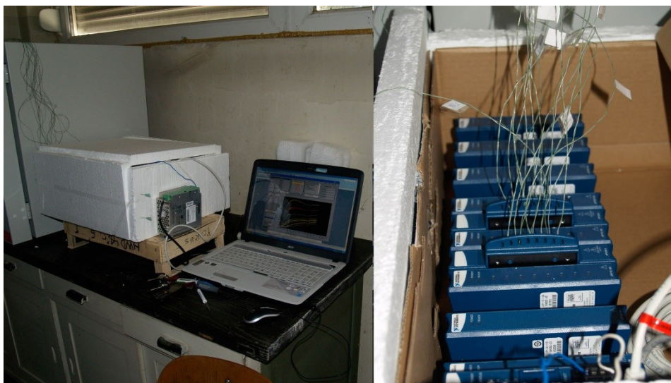
Slika 3 FieldPoint uređaj za akviziciju temperature (Foto: G. Fruk)
