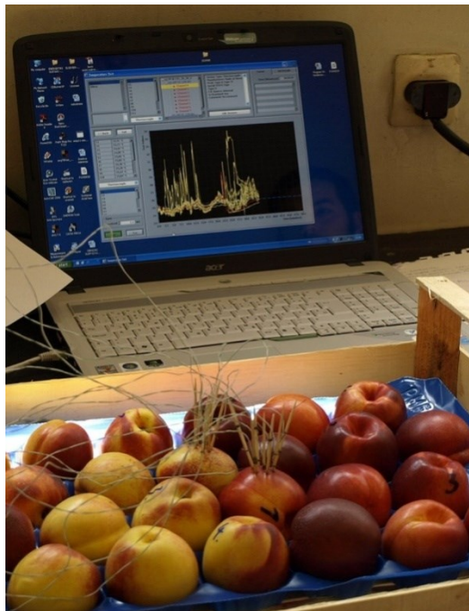
Slika 4 Mjerenje temperature u plodu nektarine pomoću termoparova (Foto: T. Jemrić)
