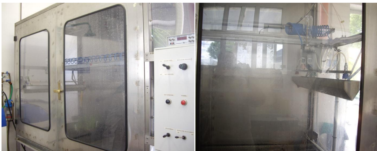
Slika 22. Zatvorena prskalica za vrijeme tretiranja (foto: V.Šoštarčić)
