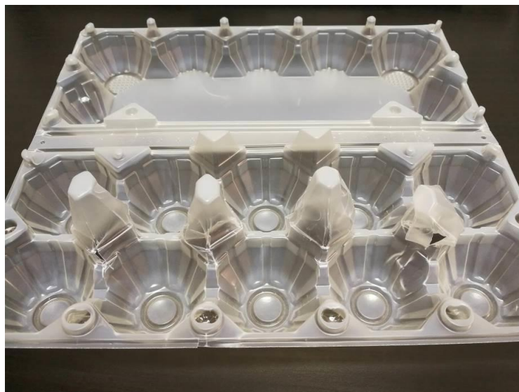
Slika 11.8. Razorena struktura središnjih stožaca polimernih kutija
