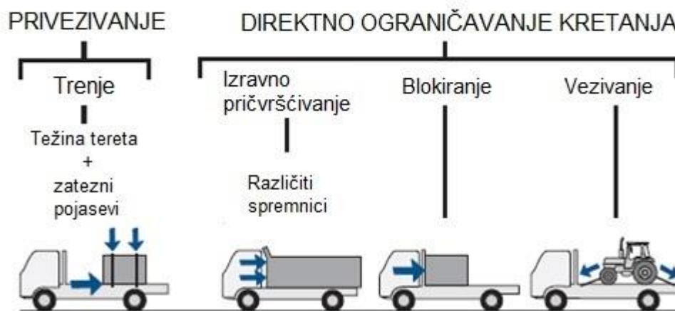
Slika 5.16. Način osiguravanja tereta prilikom transporta
