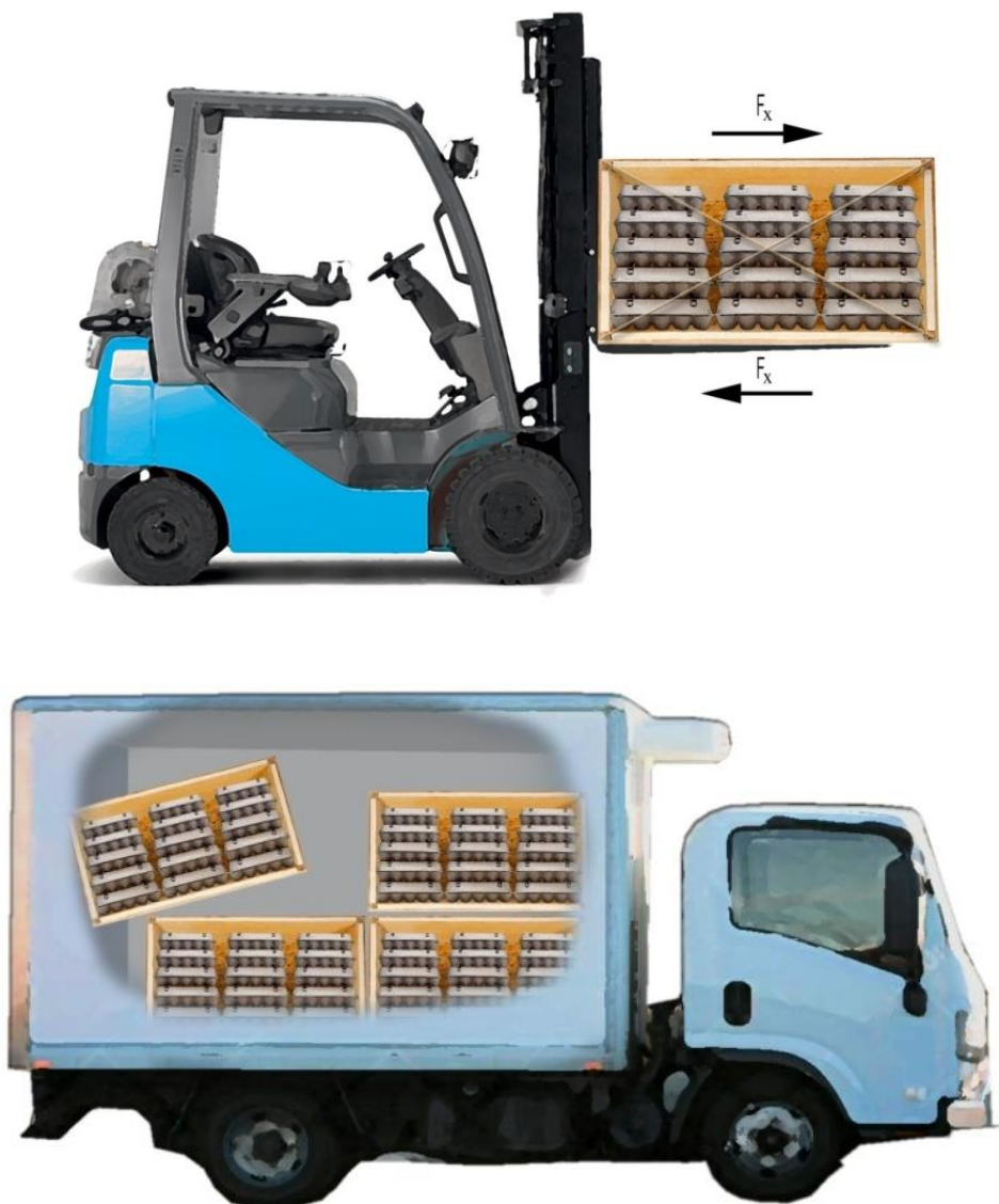
Slika 3.3. Utjecaj dinamičkih sila prilikom transporta
