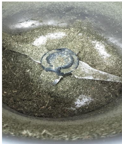
Slika 7.- Suha tvar u laboratorijskom mlinu
