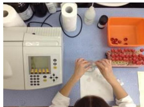
Slika 4.3.8. Određivanje apsorbancije uzorka
