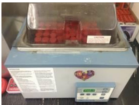
Slika 4.3.7. Uzorci u vodenoj kupelji (vlastiti izvor)
