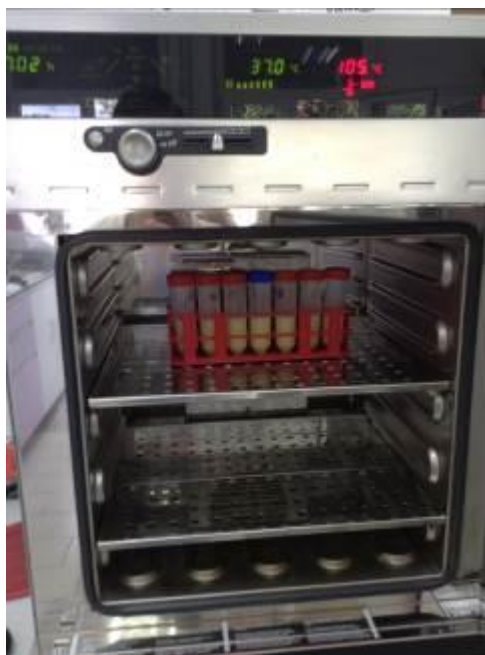
Slika 4.4.3. Uzorci u sušioniku na 37 °C tijekom određivanja inducirane lipidne oksidacije
