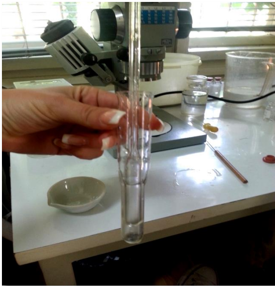
Slika 15. Drobljenje cista u Huijsmansovom homogenizatoru (Dubičanac, 2014)
