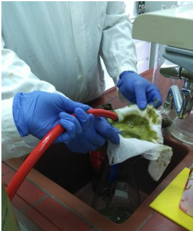
Slika 3.3.2.3. Filtriranje buražnog soka pod strujom ugljikovog dioksida
