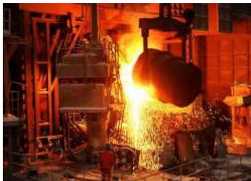
Slika 2.1. Proces proizvodnje elektropećne troske
