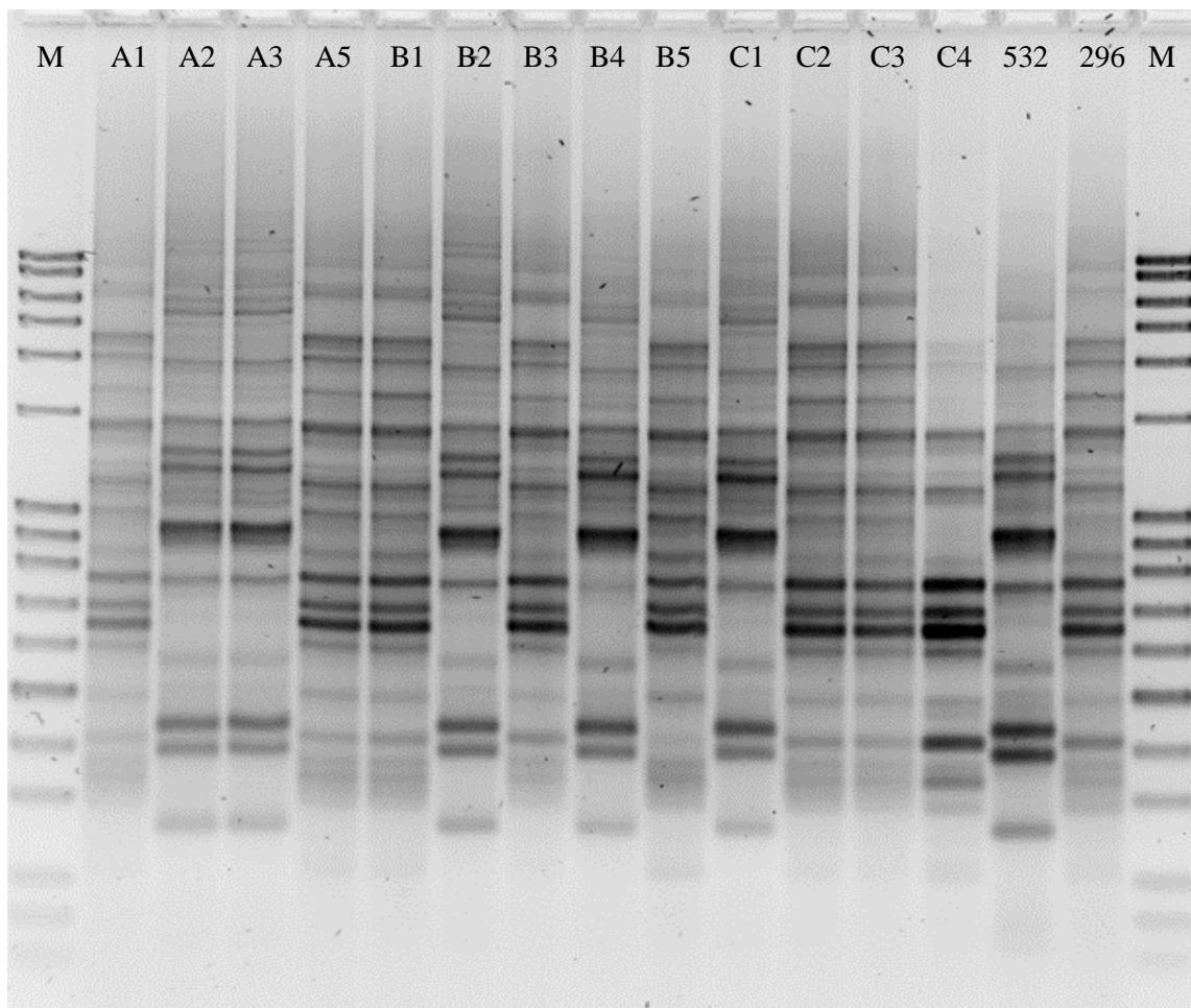
Slika 6. Rep-PCR produkti dobiveni amplifikacijom DNA izolata prikupljenih iz uzoraka kobasice inokulirane sa sojem *Lb. curvatus* MRS\_532 nakon 7 dana proizvodnje. Oznake redaka: M=marker (1 kb, Roth); A1-3,5=izolati prikupljeni sa repeticije A; B1-5=izolati prikupljeni sa repeticije B; C1-4=izolati prikupljeni sa repeticije C; 532=soj *Lb. curvatus* MRS\_532; 296=soj *Lb. sakei* MRS\_296.
