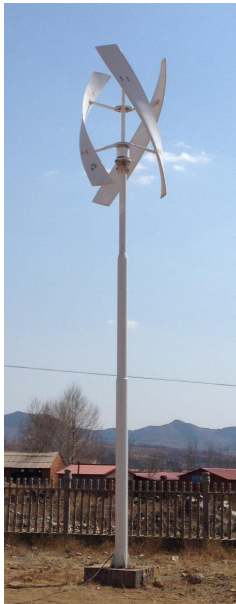
Slika 4.2.4.1. Primjer vertikalne vjetroturbine
