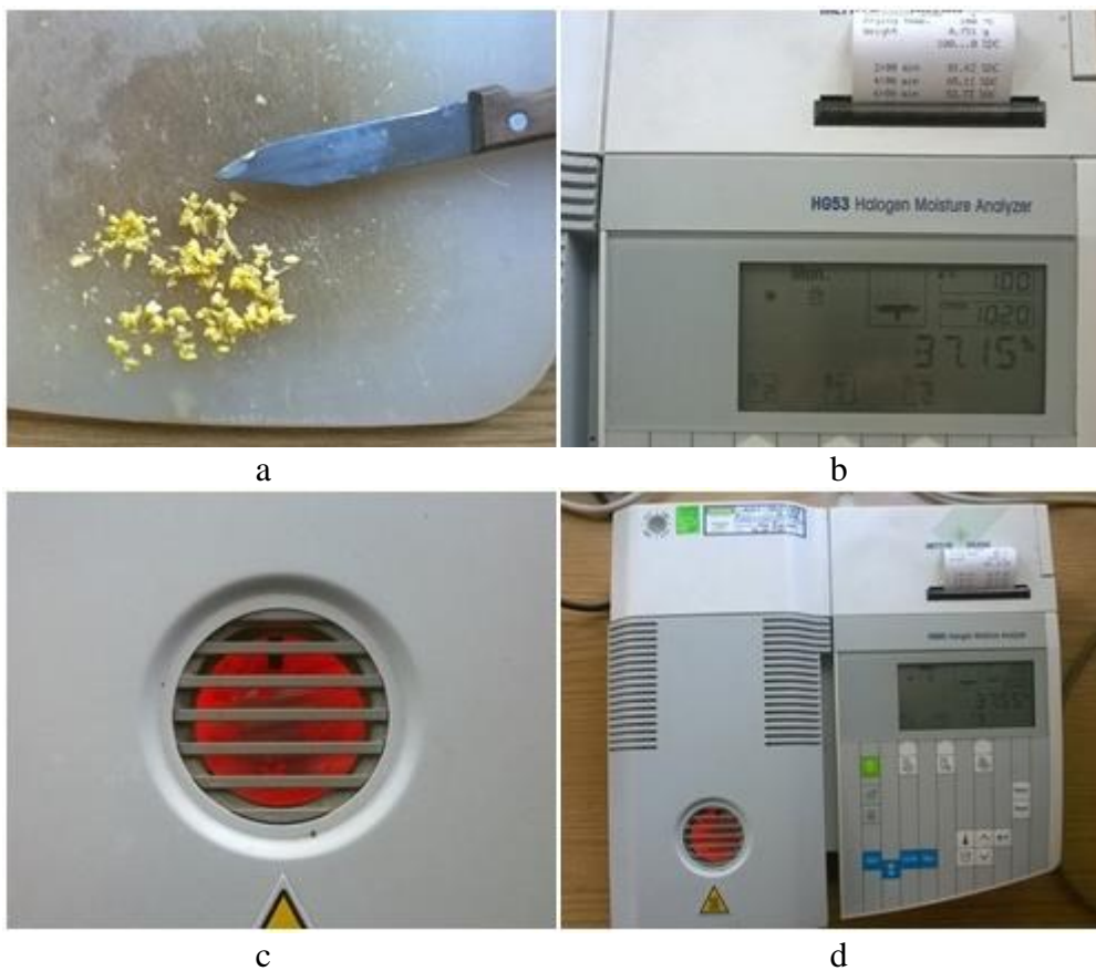
Slika 3.4.3. Mjerenje sadržaja suhe tvari u endospermu zrna, a – priprema uzorka, b – podatci na halogenom vlagomjeru, c – žarenje uzorka, d – halogeni vlagomjer
