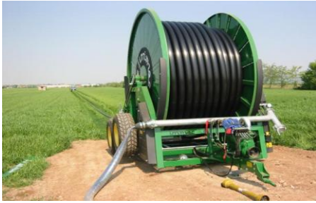
Slika 2.10. Samohodni vučeni rasprskivač (Tifon) s kišnim krilom, navodnjavanje pokusa
