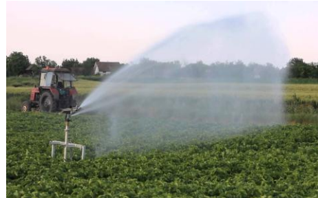
Slika 2.11. Samohodni vučeni rasprskivač (Tifon) s "topom", navodnjavanje sjemena
