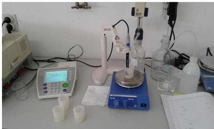
Slika 14. Određivanje pH vrijednosti (Foto: Maja Pleša, 2017)
