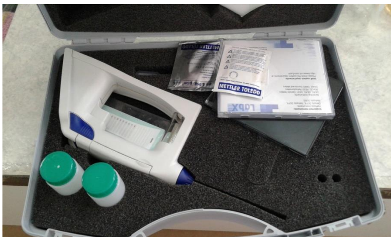
Slika 13. Digitalni denziometar (Foto: Maja Pleša, 2017)
