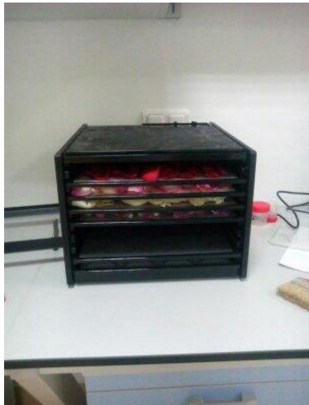
**Slika 6.** Prikaz sušenja latica ruža u dehidratoru (Excalibur dehydrator 4926T, SAD)
