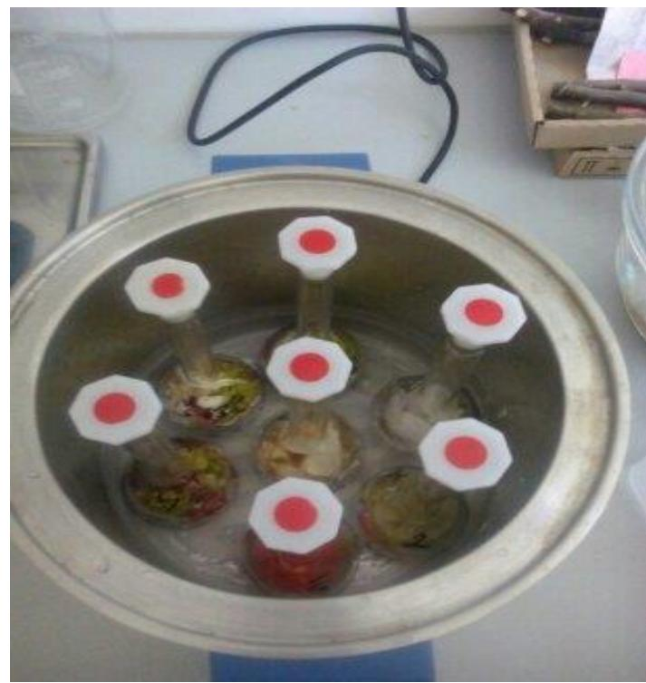
**Slika 12.** Prikaz kuhanja uzorka u parnoj kupelji u svrhu
