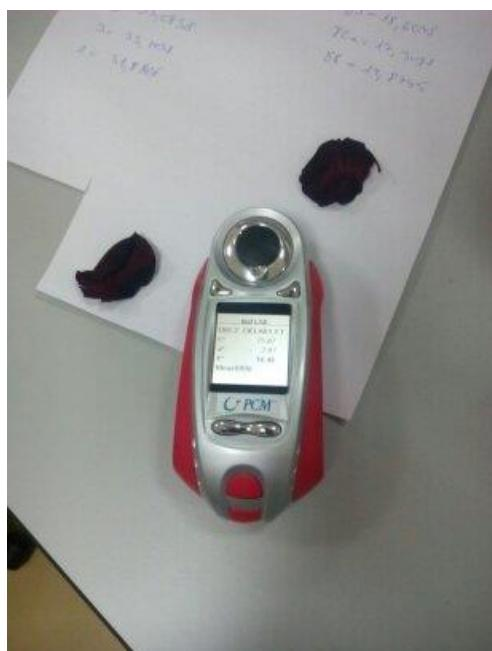
**Slika 14.** Određivanje boje pomoću kolorimetrom (Colortec PCM)
