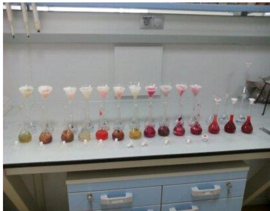
**Slika 13.** Prikaz filtriranja uzoraka nakon kuhanja u vodenoj kupelji
