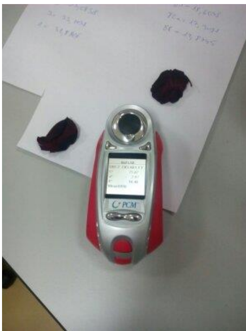
Slika 14. Određivanje boje pomoću kolorimetrom (Colortec PCM)
