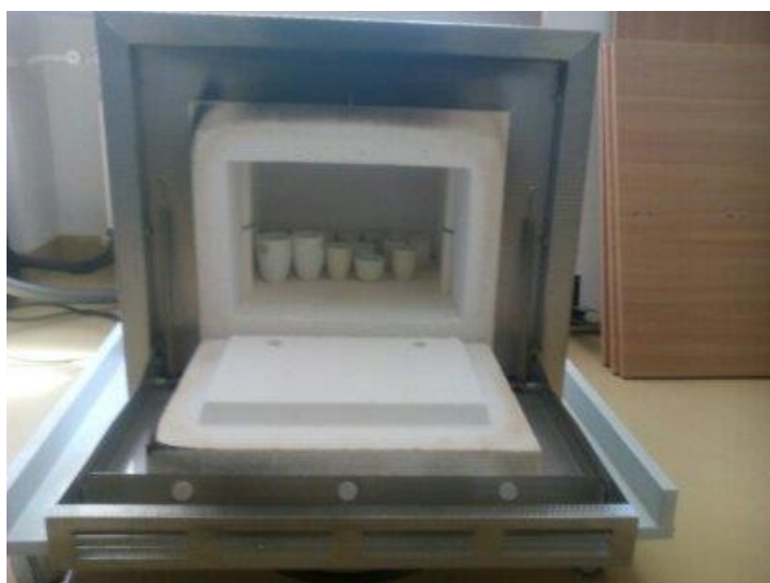
Slika 10. Prikaz sušenja ružinih latica u mufolnoj pećnici u svrhu određivanja pepela
