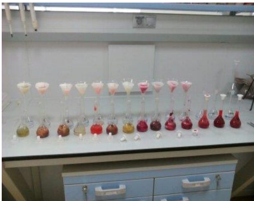
Slika 13. Prikaz filtriranja uzoraka nakon kuhanja u vodenoj kupelji (Snimila: Ivana Filipović)
