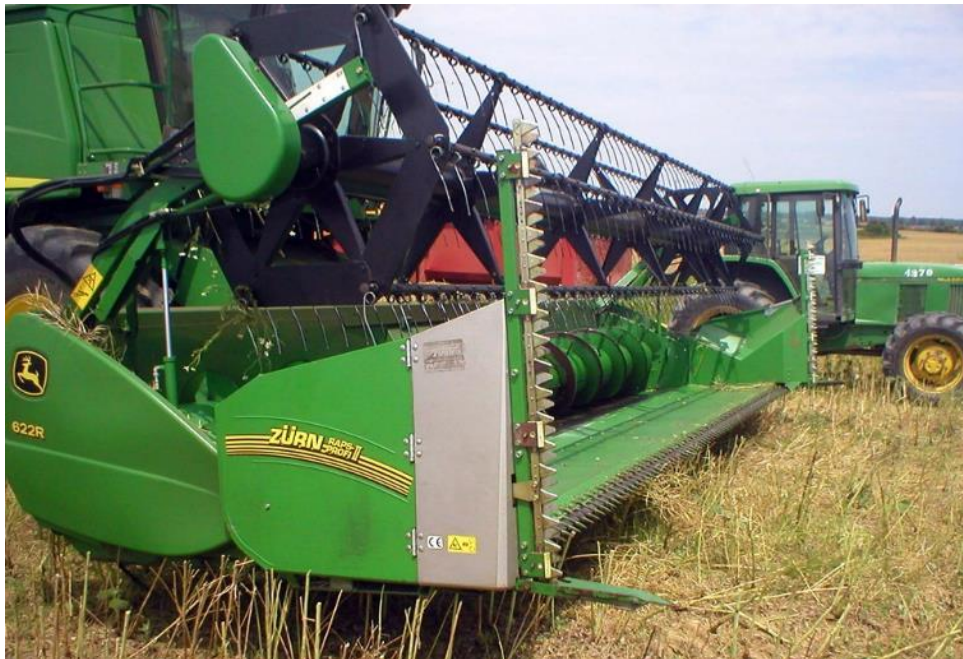
Slika 3.5. Žetveni uređaj za žetvu uljane repice opremljen s dvije vertikalne kose i produženim stolom-platformom (John Deere)
