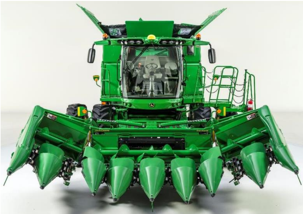
Slika 3.3. Univerzalni žitni kombajn sa sklopivim žetvenim uređajem za berbu kukuruza (John Deere)
