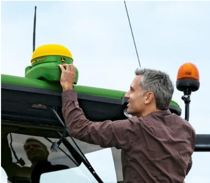
Slika 6.13. GPS antena i njezina instalacija na kombajnu (John Deere)
