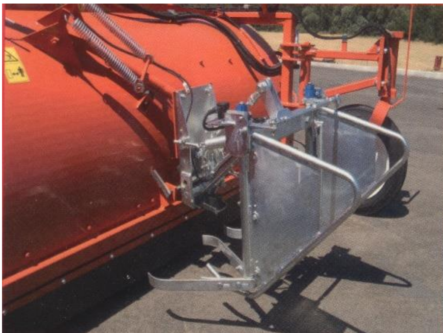
Slika 6.19. Ticala senzora za vođenje uređaja za pripremu i vađenje šećerne repe Izvor: Zimmer i sur., 2009.
