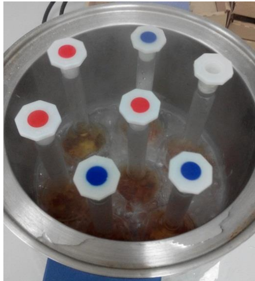
Slika 6.6.2. Uzorak za određivanje škroba u vodenoj kupelji
