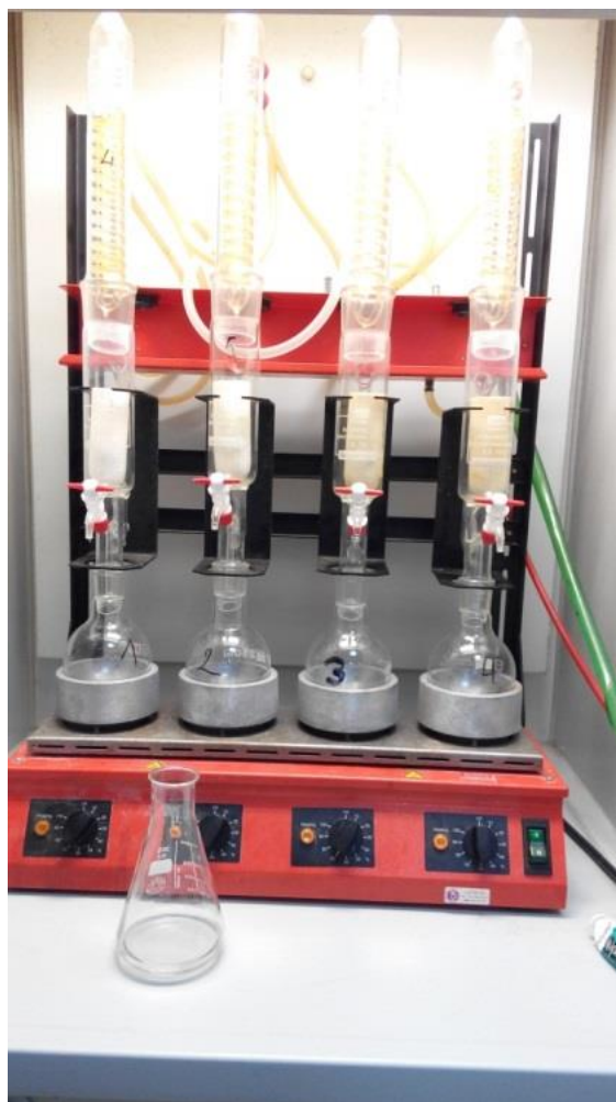
Slika 6.5.1. Soxhlet ekstraktor za određivanje masti
