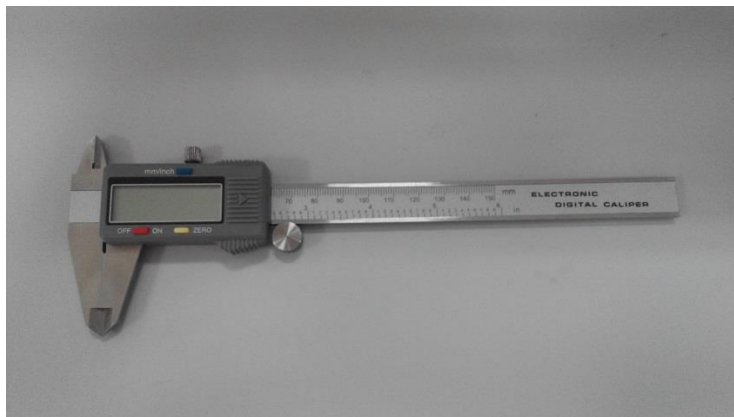
Slika 6.1.1. Digitalno mjerilo Digital Caliper 0-150 mm
