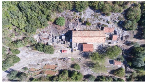
Sl.7.2.2. Obiteljsko imanje tradicionalne gradnje s mnoštvom suhozidnih oblika: gumno, gustjerna, klačina, bravariva, obor, podzidi, omeđeni poljski put.
