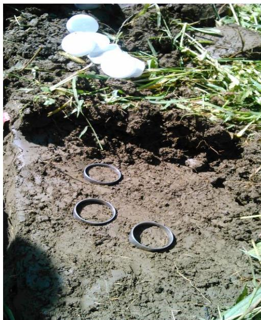
Slika 7. Uzimanje uzorka pomoću cilindra iz profila tla
