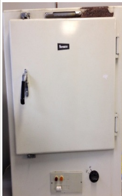
Slika 8. Peć za sušenje tla
