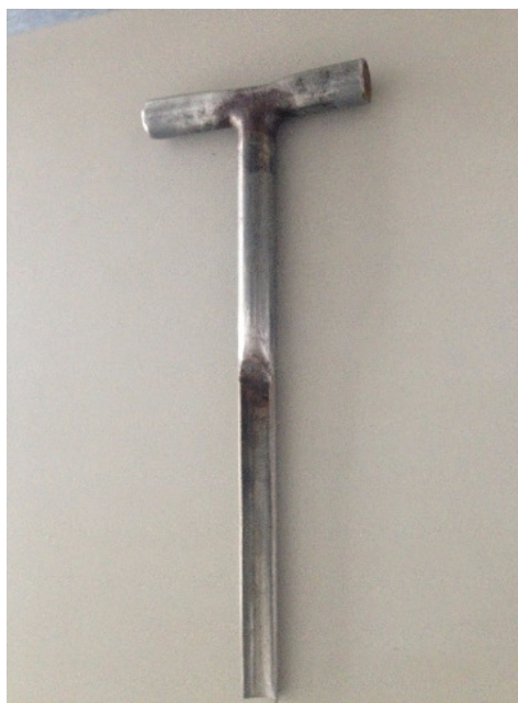
Slika 7. Sonda za uzorkovanje tla
