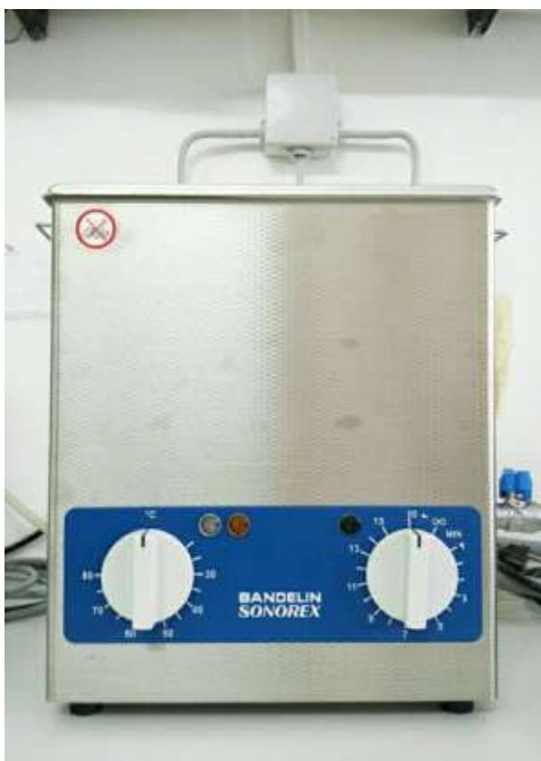
Slika 4. Ultrazvučna kupelj „Bandelin“ RK 103H
