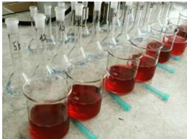
Slika 3. Priprema vodenih uzoraka za određivanje sadržaja osnovnog kemijskog sastava
