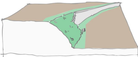
Slika 3.47. Kombinacija suhozida i zemljanog nasipa
