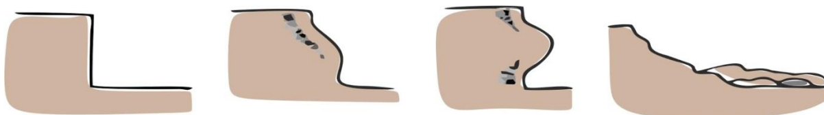
Slika 2.17. Utjecaj pritiska tla na zid; Izvor: http://www.alpter.net/IMG/pdf/UNIMI_bonardi_11_05.pdf
