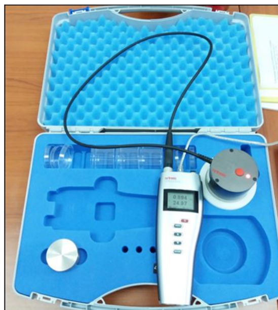
Slika 3.5. HygroPalm HP23 Rotronic uređaj za mjerenje aktiviteta vode s HC2 –AW mjernom glavom Izvor: vlastito istraživanje
