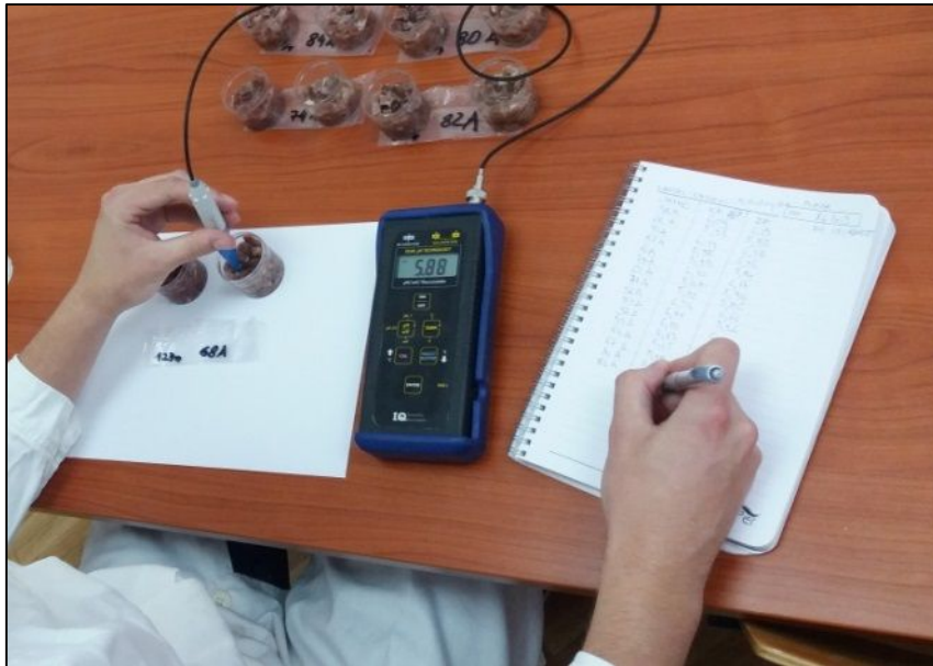
Slika 3.8. Očitavanje pH vrijednosti
