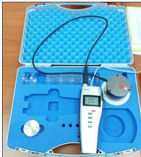
Slika 3.5. HygroPalm HP23 Rotronic uređaj za mjerenje aktiviteta vode s HC2 –AW mjernom glavom
