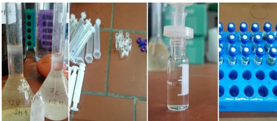
Slika 6: Prikaz dobivene otopine, filtra, šprica i viala te pripremljenih uzoraka za analizu (Izvor: Barkijević, 2016)
