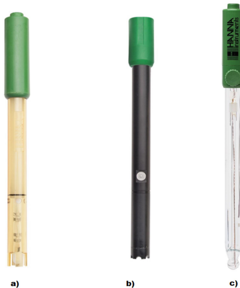
Slika 6. Sonde za mjerenje a) elektroprovodljivosti, b) količine otopljenog kisika, c) pH vrijednosti. (Izvor: Hanna Instruments 2017. http://hannainst.com/edge-ph.html )
