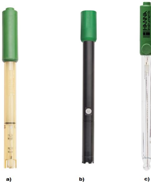
Slika 6. Sonde za mjerjenje a) elektroprovodljivosti, b) količine otopljenog kisika, c) pH vrijednosti. (Izvor: Hanna Instruments 2017. <http://hannainst.com/edge-ph.html>)
