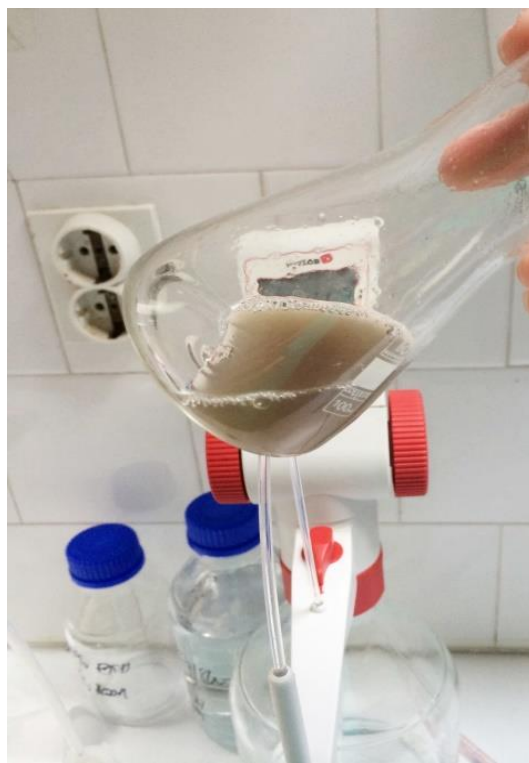
Slika 9: Metoda direktne titracije uzorka
