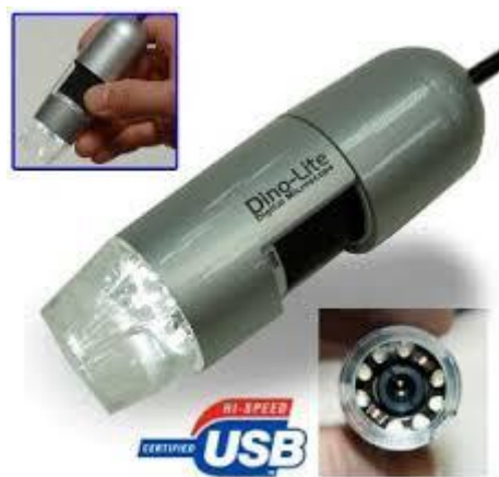
Slika 15: Digitalni mikroskop Dino-Lite (Amazon.com)
