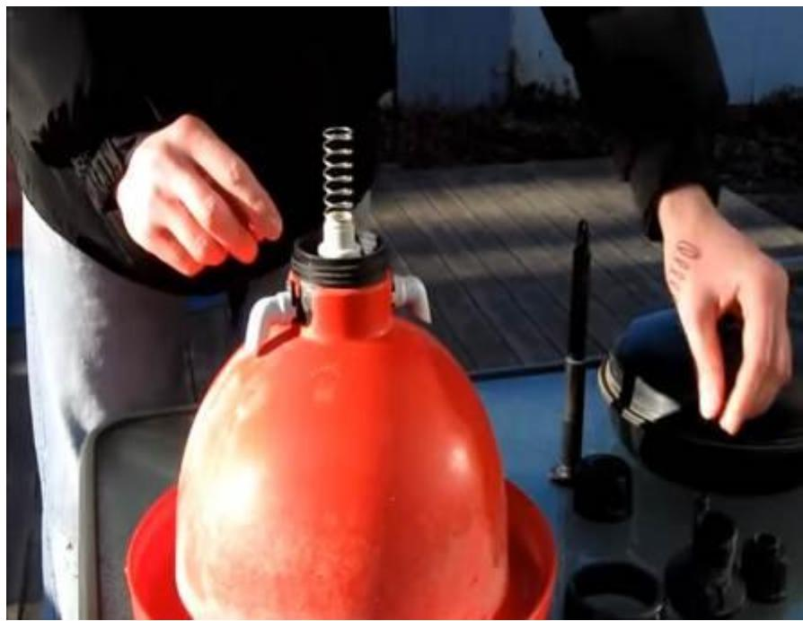
Slika 47. Elastična opruga viseće automatske pojilice
