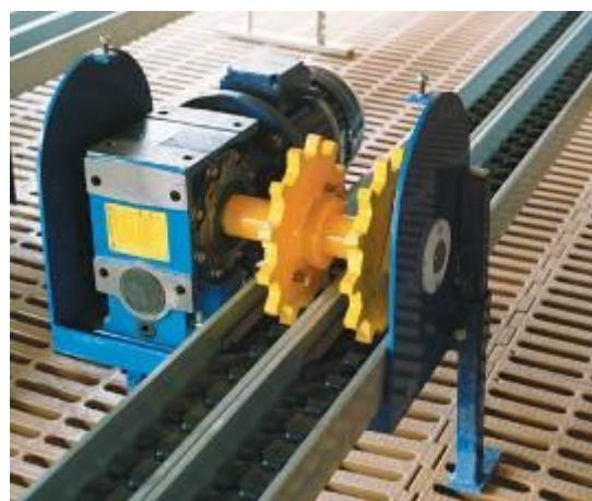
Slika 37. Reduktor za pogon beskrajnjog lanca lančano distributivnog transportera
