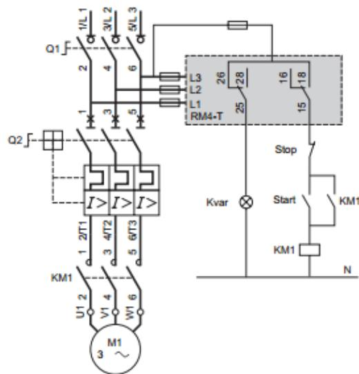
Slika 41. Shematski prikaz spajanja trofaznog vremenskog releja
