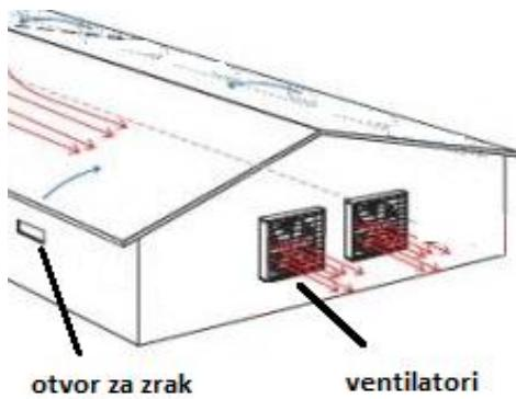
Slika 56. Prikaz postavljanja ventilatora i otvora za zrak
