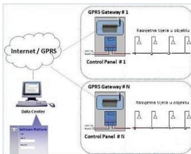
Slika 54. Shematski prikaz upravljanja rasvjetom u objektima (1-N)
