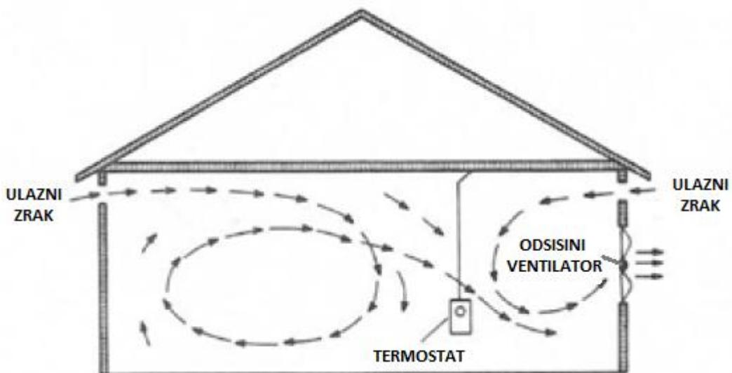
Slika 5. Tipični odsisni sustav ventilacije peradarnjaka
