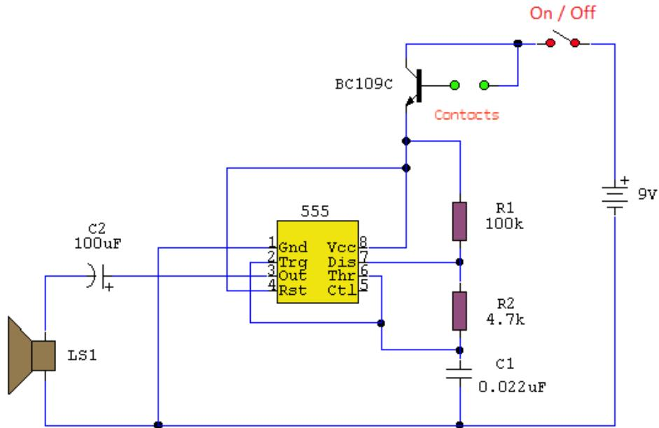
Slika 59. Shema alarmnog sustava za zaštitu od poplave
