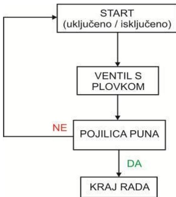
Slika 44. Dijagram rada automatskog sustava napajanja pilića
