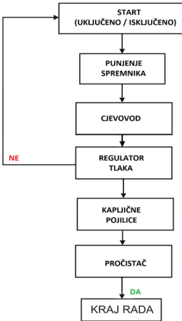
Slika 49. Dijagram rada automatskog sustava napajana pilića
