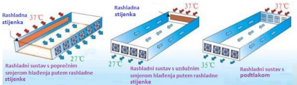
Slika 6. Prikaz načela rada rashladnog sustava s podtlakom
