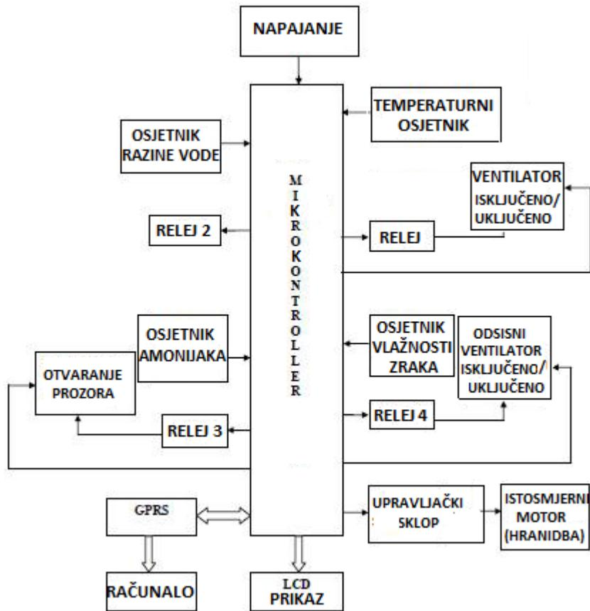
Slika 2. Blok dijagram automatskog sustava kontrole u peradarskoj proizvodnji
