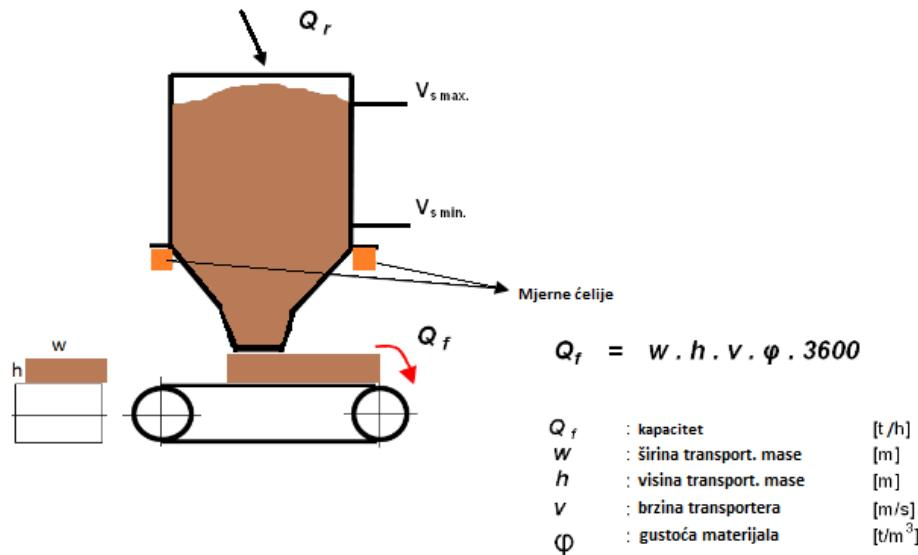
Slika 15. Parametri vođenja i upravljanja usipnog koša i transporterja
