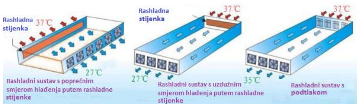
Slika 6. Prikaz načela rada rashladnog sustava s podtlakom
