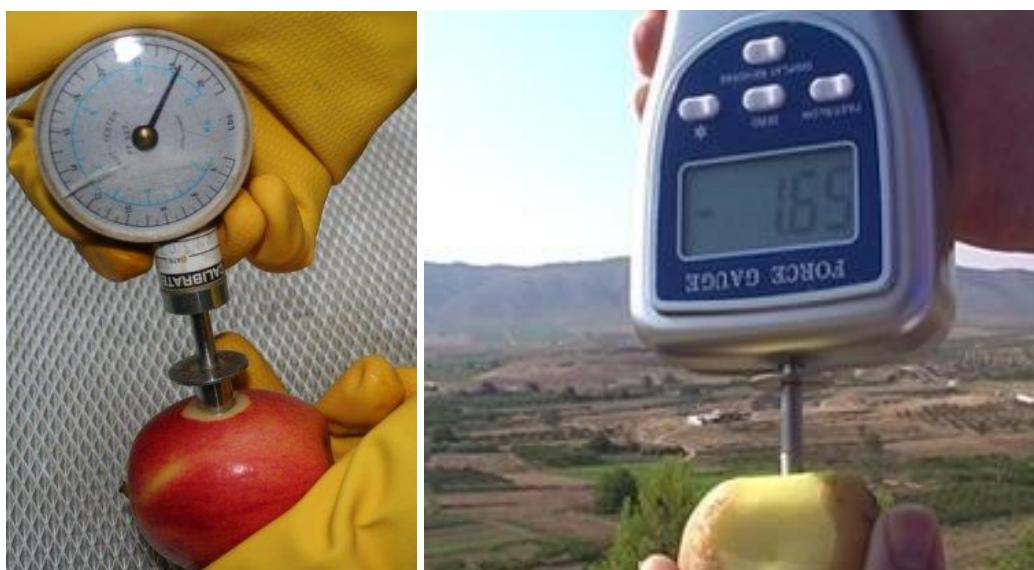
Slika 2. Ručni i digitalni penetrometar ([www.pinova.hr](http://www.pinova.hr))
