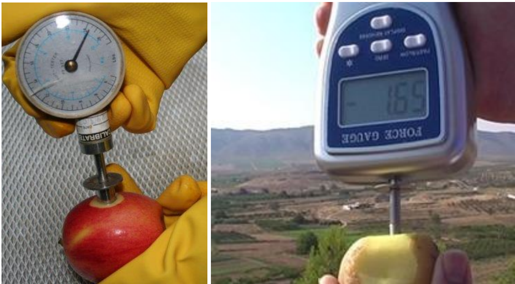
Slika 2. Ručni i digitalni penetrometar (www.pinova.hr)
