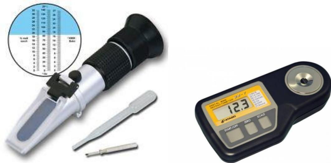
Slika 3. Optički i digitalni refraktometar ([www.pinova.hr](http://www.pinova.hr))
