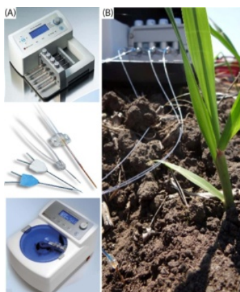
Slika 25 Metoda mikrodijalize. (A) Dijelovi uređaja: pumpa, sonde i autosampler; (B) In situ praćenje flukseva dušika u tlu (Inselsbacher et al., 2011).
