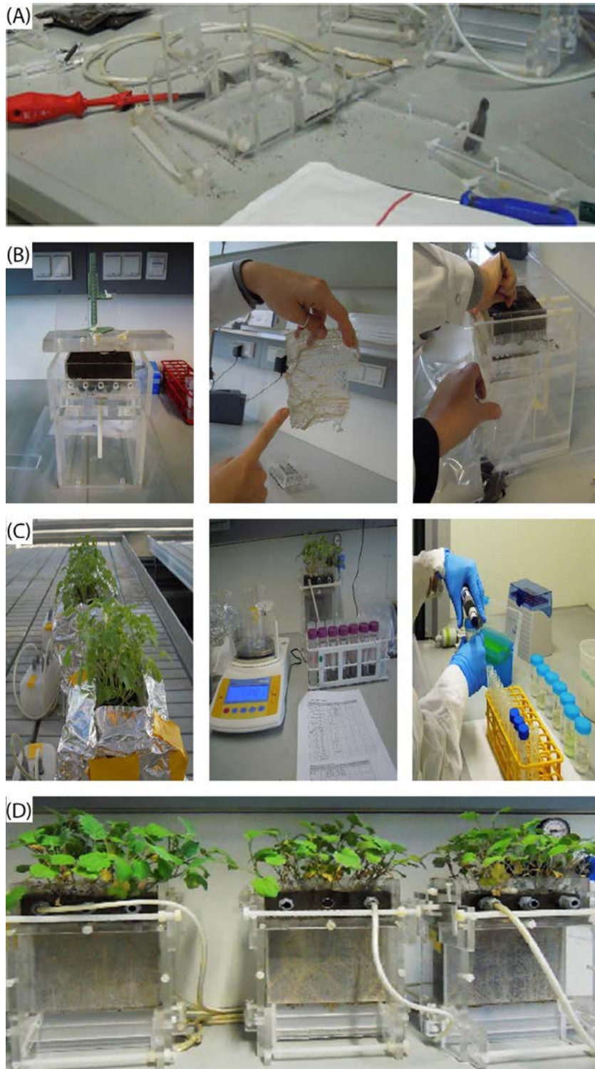
Slika 15 Tijek rizoboks eksperimenta. (A) Sastavljanje rizoboksa; (B) Sakupljanje slojeva tla na različitoj udaljenosti od korijenja; tepih korijenja ispran s membrane; (C) Rizoboksovi u stakleniku; pripreme za ekstrakciju tla i digestiju; (D) Postavljanje eksperimenta u 3 ponavljanja.
