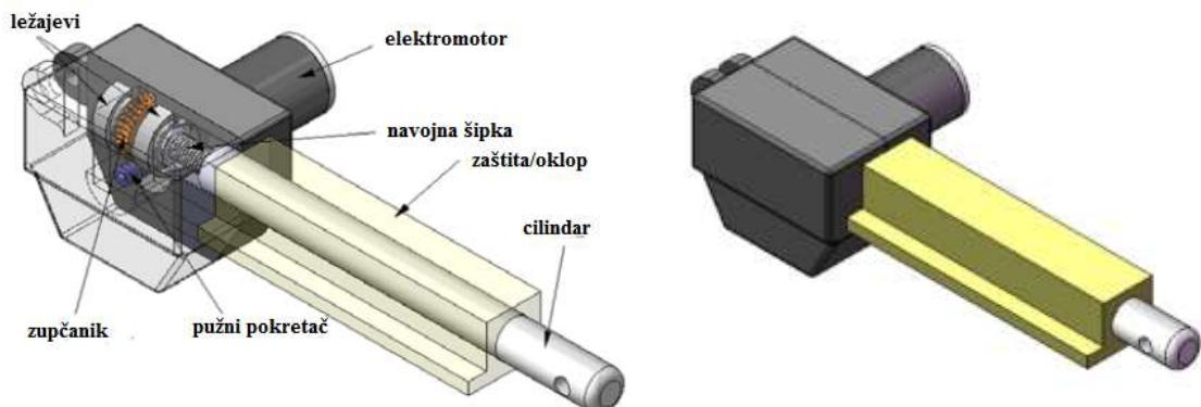
Slika 12. Sastavni dijelovi elektromotora sa zupčastim prijenosom
