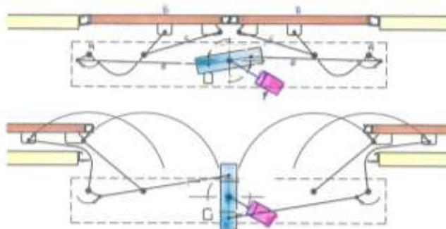
Slika 2. Sustav električnog upravljanja vratima zamahom
