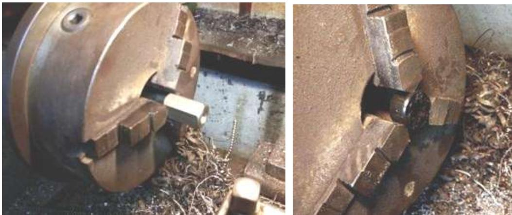
Slika 58. Tokarenje matice i plastičnih prstenova
