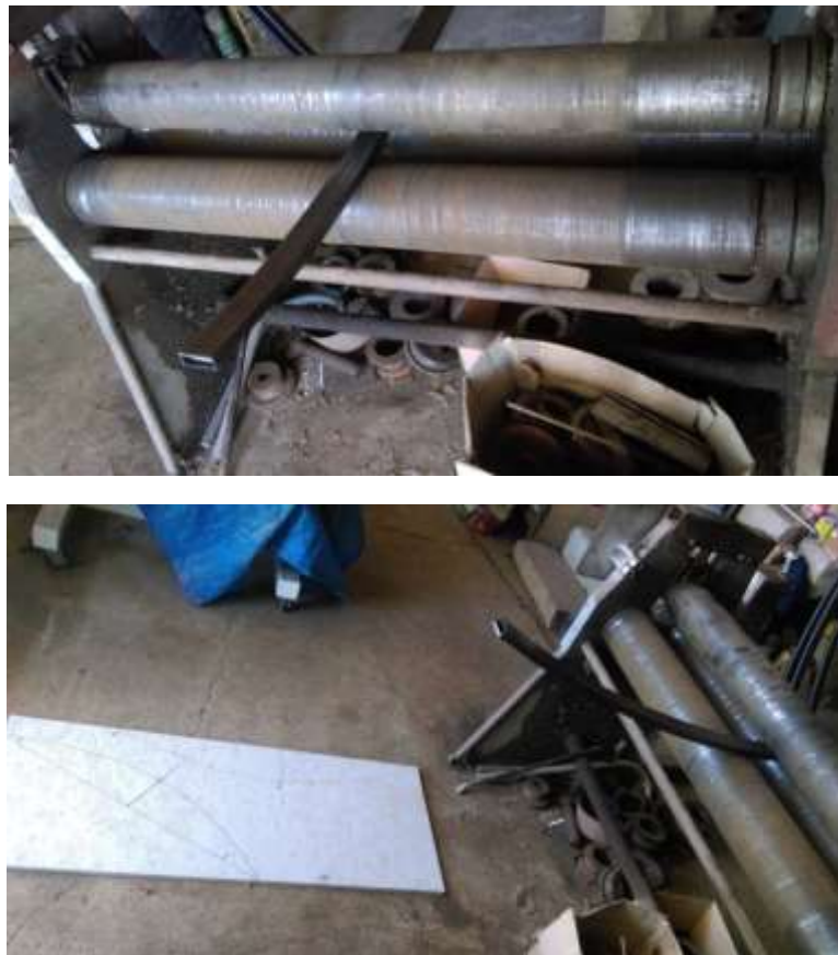
Slika 39. Savijanje željezne cijevi za oluk modela traktorske kabine
