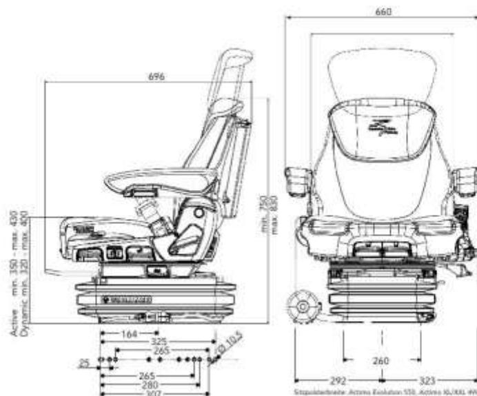
Slika 18. Suvremeno traktorsko sjedalo s pneumatskim ogibljenjem
