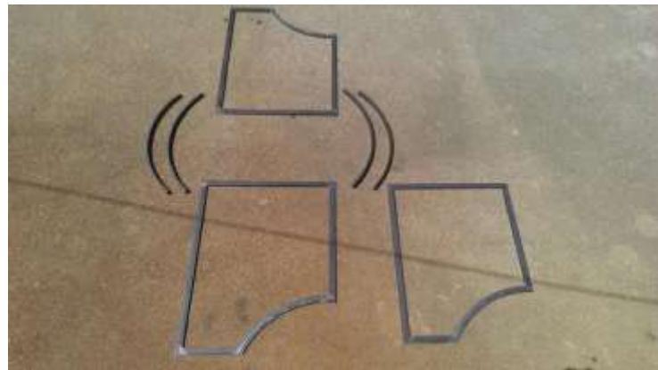
Slika 40. Pripremne komponente za sklapanje modela traktorske kabine
