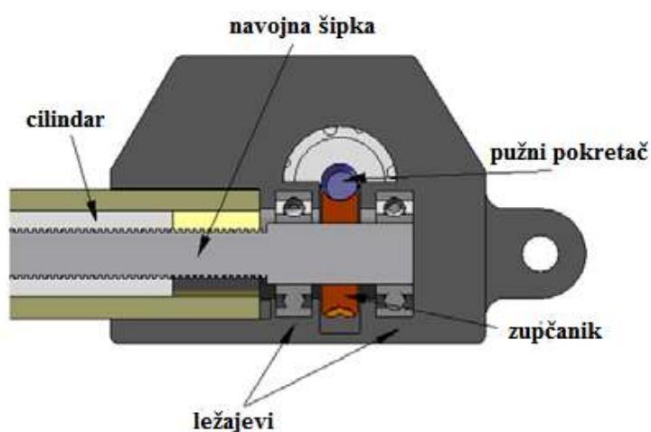
Slika 13. Presjek elektromotora – prijenos
