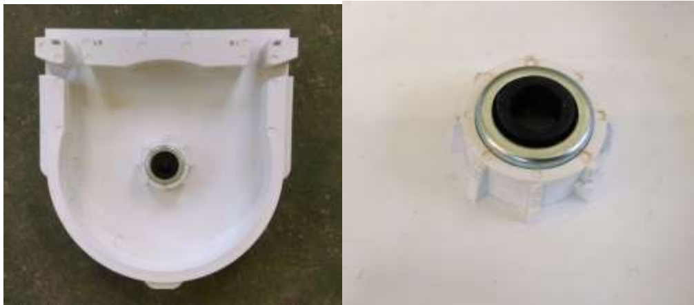
Slika 48. Prilagođen poklopac kutije i kuglični ležaj
