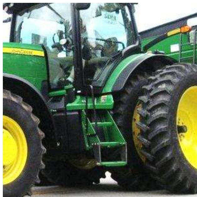
Slika 26. Prikaz odmaknutih stuba na traktoru John Deere 8235 R
