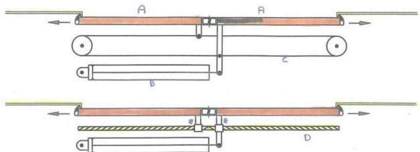
Slika 4. Sustava pneumatskog upravljanja kliznim vratima
