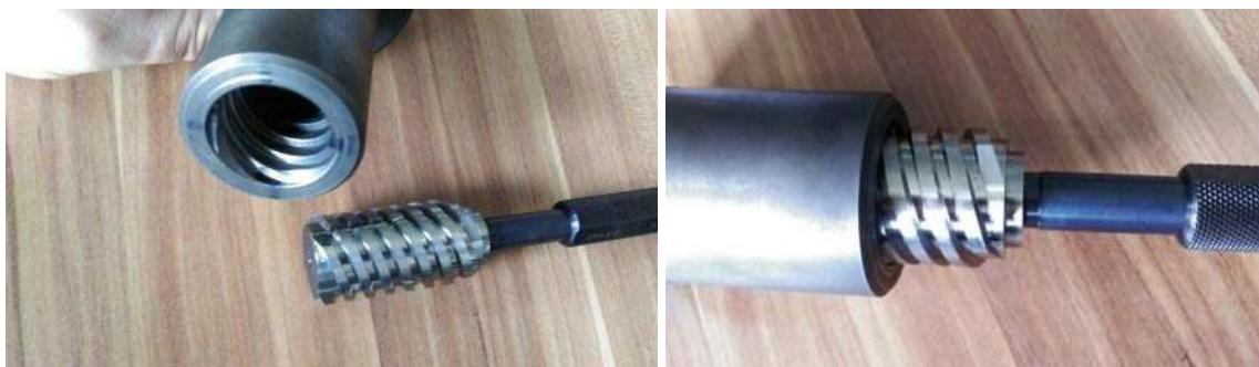
Slika 67. Kontrolni trn (kalibar) za trapezni navoj koraka 28 mm
