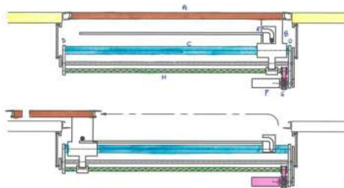
Slika 9. Sustav električnog upravljanja kliznim vratima na pomak
