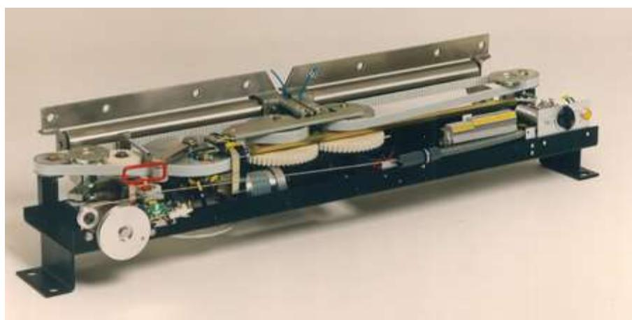
Slika 8. Uređaj za upravljanje vratima pomoću kliznog pomaka
