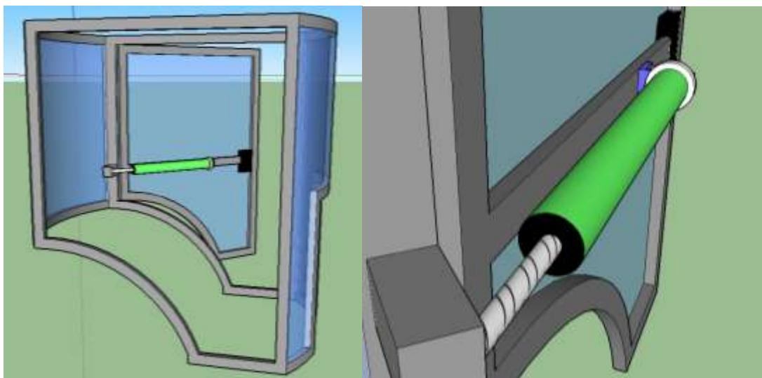
Slika 53. Položaj цивног електромотора у случају с навојном шипком
