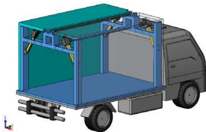
Slika 15. Izgled vozila sa zatvorenim vratima pomoću elektromotora
