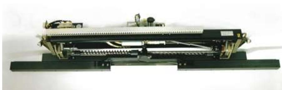
Slika 11. Uređaj za upravljanje vratima na klizni pomak
