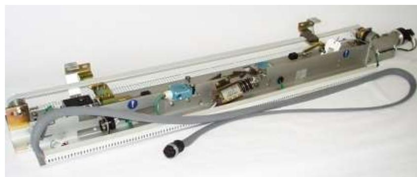
Slika 6. Uredaj za upravljanje vratima pomoću elektromotora
