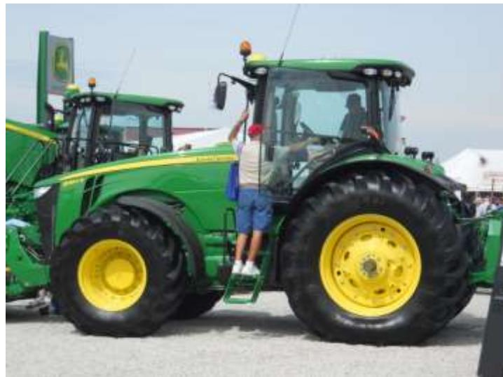
Slika 20. Prikaz konstrukcije kabine s velikim staklenim površinama
