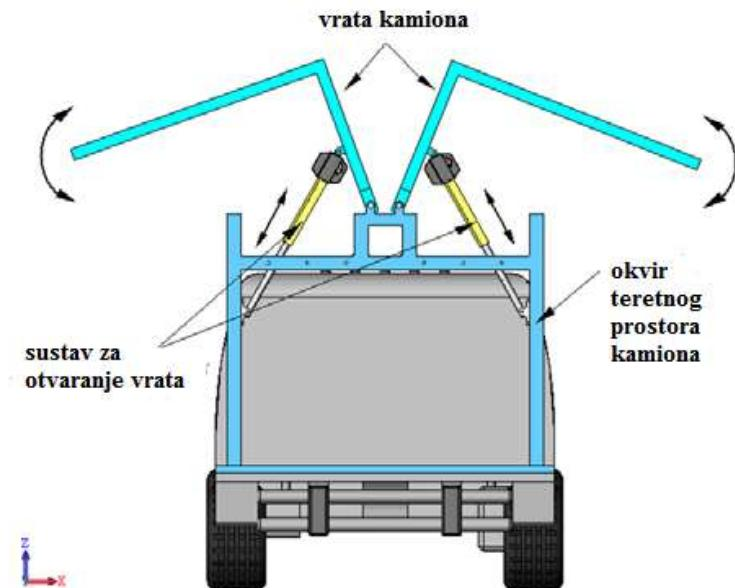
Slika 14. Prikaz djelovanja elektromotora na otvaranje vrata
