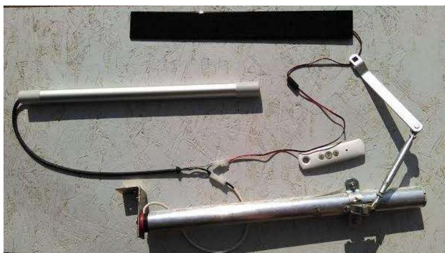
Slika 42. Elementi sustava daljinskog upravljanja vratima traktora
