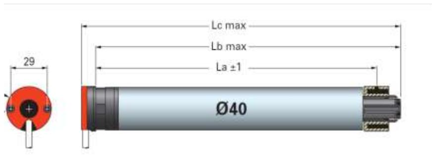
Slika 43. Cijevni elektromotor – dimenzije
