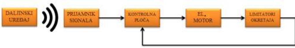
Slika 52. Blok shema komunikacije sustava daljinskog i elektromotora
