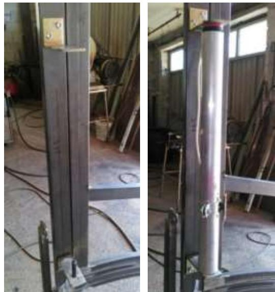
Slika 49. Držači cijevi cijevnog elektromotora
