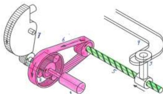
Slika 10. Princip rada prijenosa energije s elektromotora na navojnu šipku
