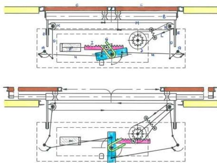
Slika 7. Sustav pneumatskog upravljanja vratima pomoću kliznog pomaka
