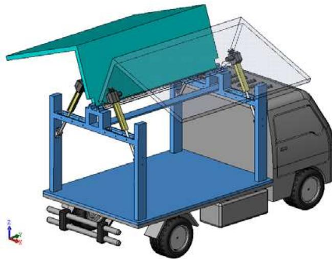
Slika 16. Izgled vozila s otvorenim vratima pomoću elektromotora
