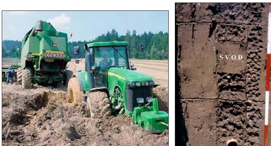
Slika 23. Prikaz gaženja tla teškim strojevima u nepovoljnim uvjetima vlažnosti i prikaz formiranja svoda u podoraničnoj zoni drenažnog jarka
