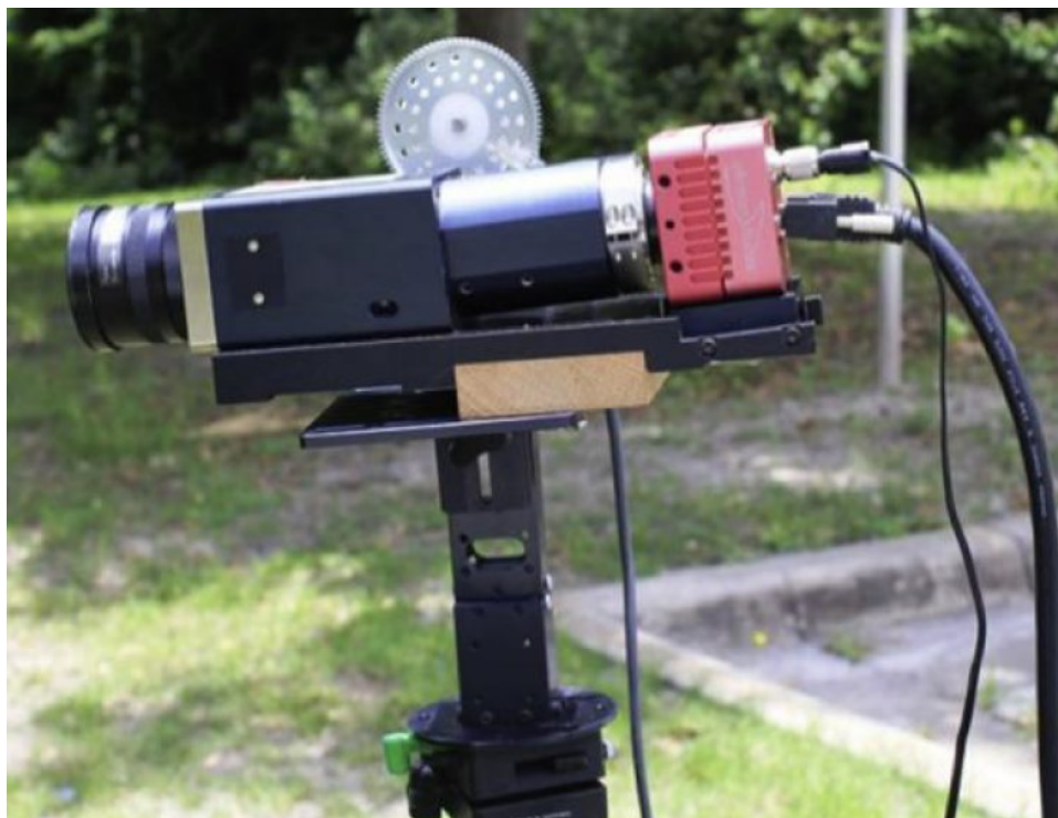
Slika 14.- Hiperspektralna kamera sa linijski skenirajućim spektrometrom (Yang i sur., 2014.)
