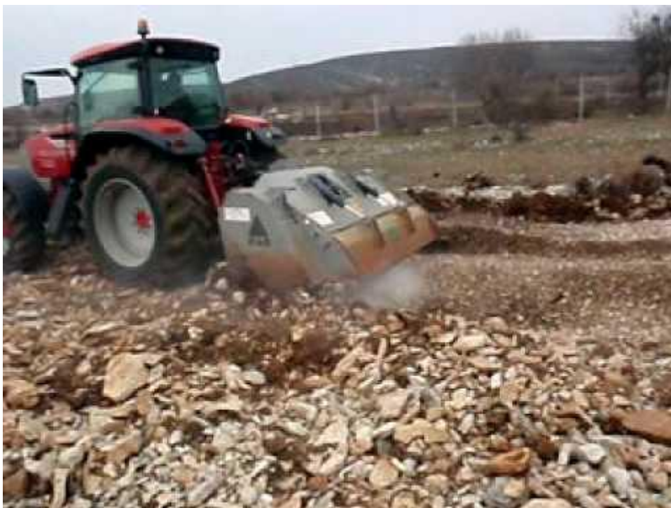
Slika 7. Frezanje kamena (Izvor: Rajner Perica)
