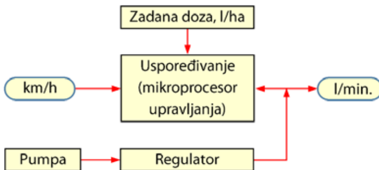
Slika 1. Shematski izgled kontrolnog sustava (Izvor: vlastita fotografija)
